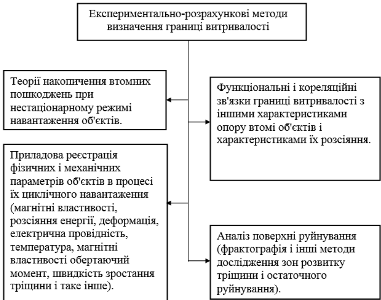
Рисунок 1.10 – Класифікація експериментально-розрахункових методів визначення границі витривалості (за суттю початкових теоретичних передумов)
