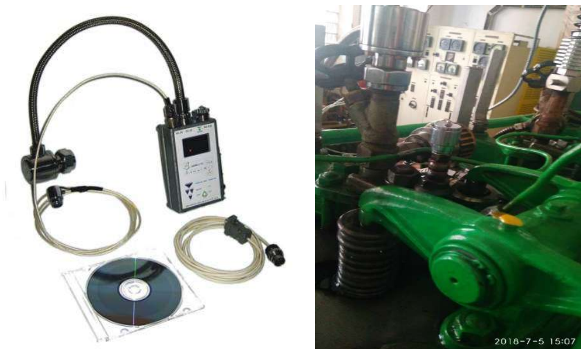
Рисунок 2.5 – Система DEPAS D4.0H. Приклад установки датчиків системи.
