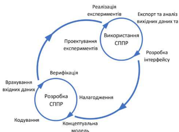
Рисунок 6.4 – Схема життєвого циклу проекту створення та використання СППР при циклічному розвитку та використанні [226]
