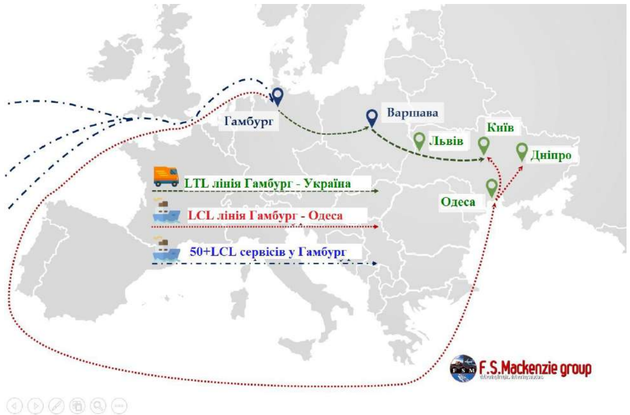
Рисунок 1.6 – Приклад схеми доставки збірних експортних вантажів у Гамбург різними видами транспорту
