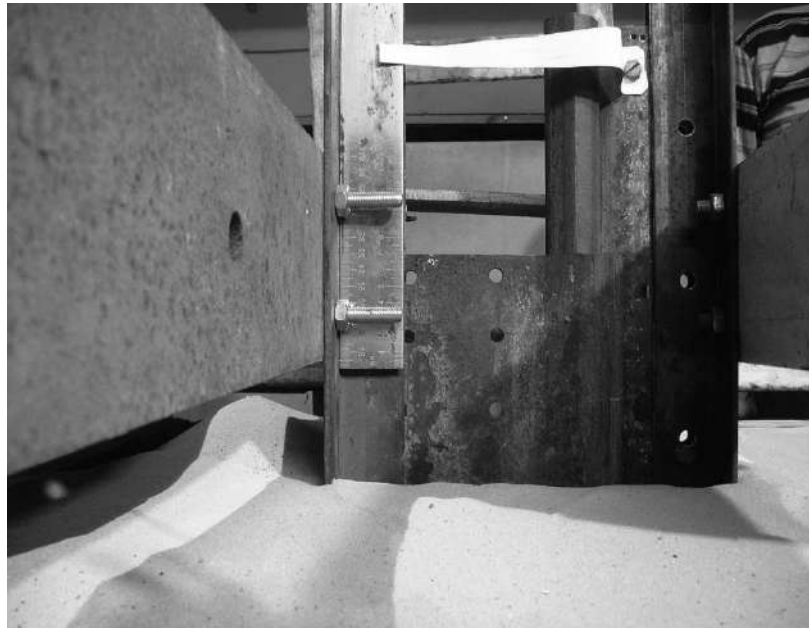
Рис. 2.17, б. Лабораторне моделювання взаємодії піщаного ґрунту із замковими з'єднаннями шпунтових паль (вертикальне розміщення замкових з'єднань): фронтальні види на експериментальну установку при моделюванні взаємних зсувів шпунтових паль
