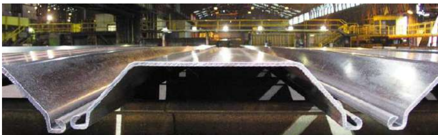
Рис. 1.6. Гарячевальцьовані сталеві одиночні шпунтові палі коритного профілю (на прикладі виробництва ArcelorMittal)
