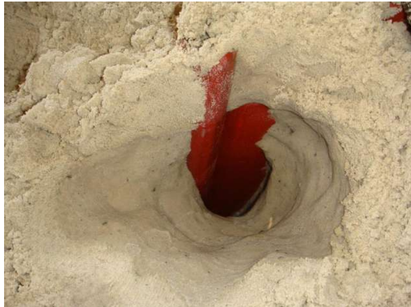
Мал. А.9. Занурення елемента шпунтової палі для використання в якості базового (фіксованого)
