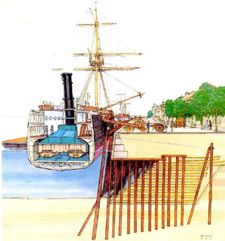
Рис. 1.3. Набережна-естакада на дерев'яних палях с бетонною надбудовою.
