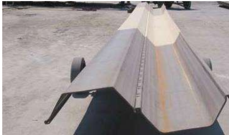
Рис. 4.3. Пакет із двох сталевих шпунтин коритного профілю, з'єднаних у замках обтисканням у заводських умовах
