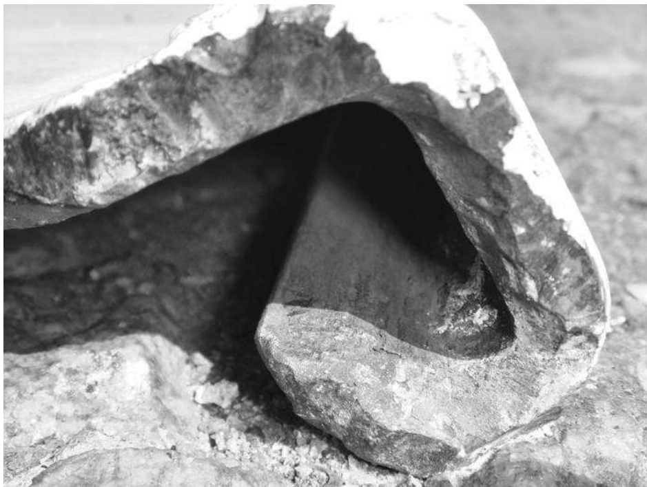
Рис. 2.8. Замок шпунтової палі після її витягування
