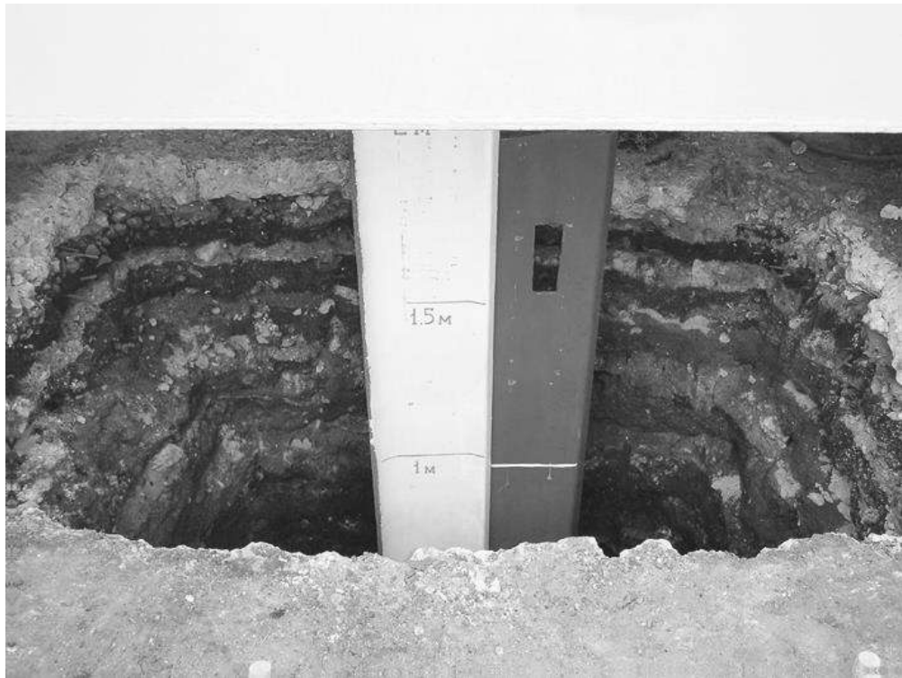
Рис. 2.9. Рухомий пальовий елемент (праворуч), який вдавлюється і витягується через замкове з'єднання фіксованого елемента
