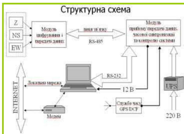
Рисунок 2.28 Структурна схема сейсмічної станції «DAS-05» Амплітудно-частотна характеристика цифрової сейсмічної станції розрахована генераторним способом за спеціальною програмою. Зареєстровані
