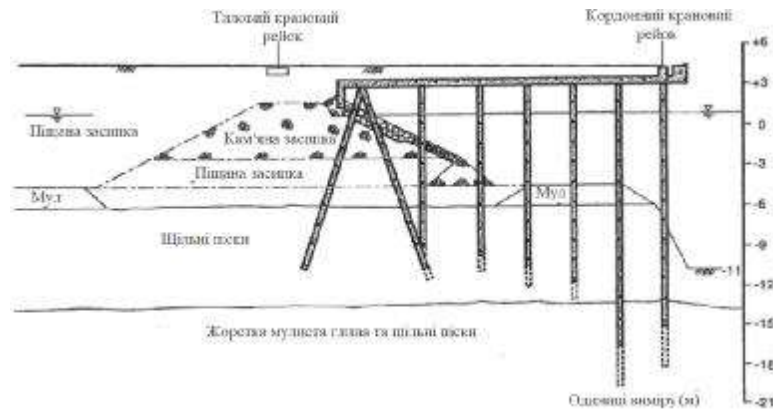
Рисунок 1.5. Схема причального Терміналу 7-ї Вулиці, Порту Окленду, з ґрунтовою основою і системою палів.
