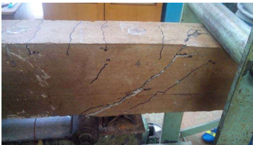
Рис. 3.13 Руйнування зразка при навантаженні 2750 кгс
