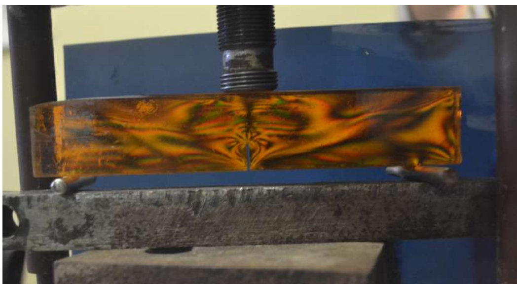
Рис. 3.2 Зміна напружень при навантаженні зразка із епоксидної смоли
