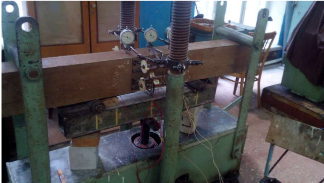
Рис. 2.9 Загальний вигляд залізобетонної балки на установці
