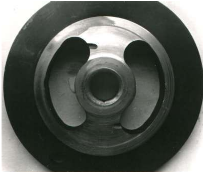
Рис. 3.1. Зношення сфери розподільника в зоні високого тиску
