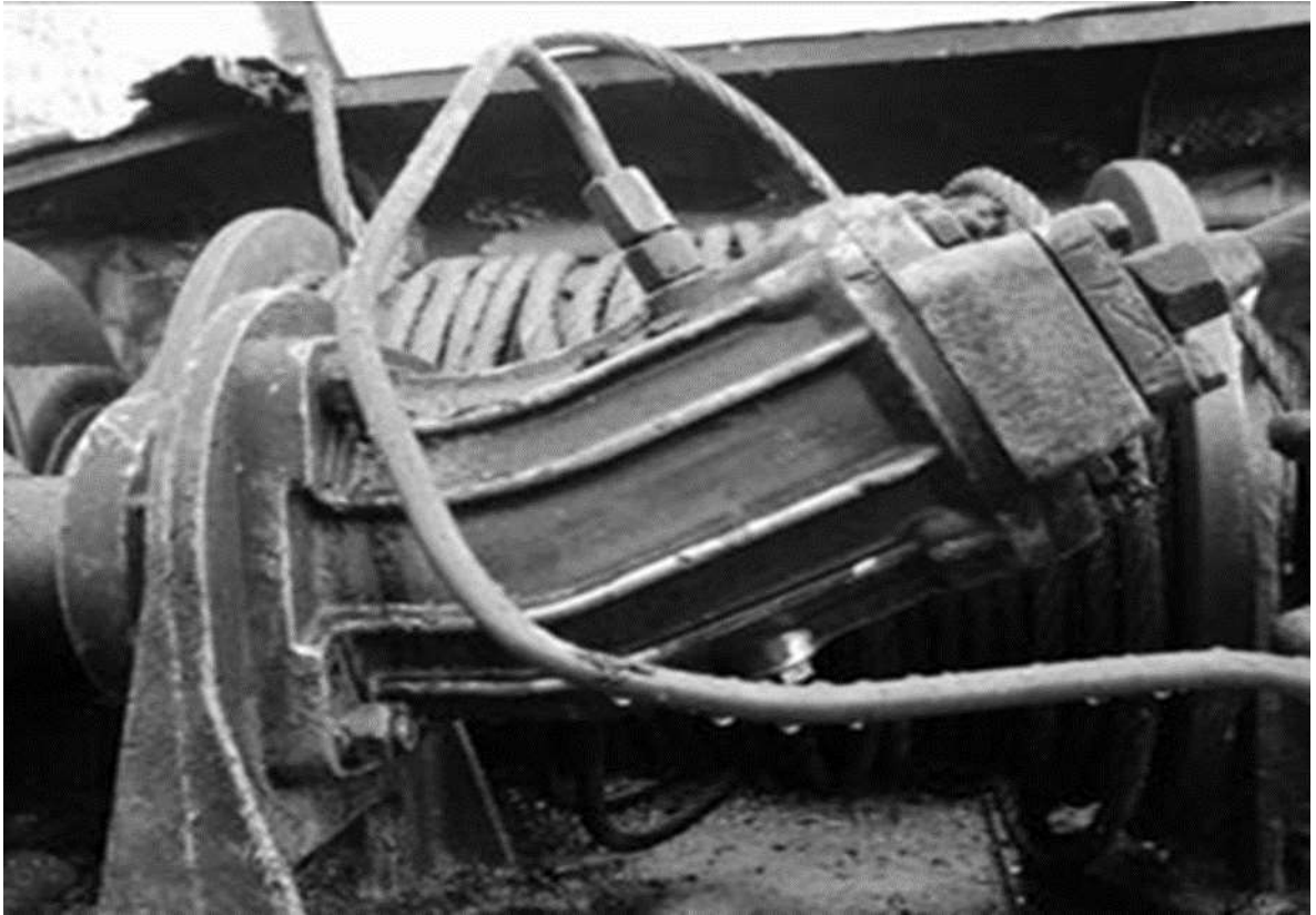
Рис. 6.7 Гідромотор 210.25 у приводі автодорожнього крана при здійсненні будівельних робіт
