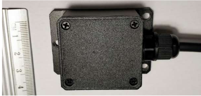
Рис. 3.30 Акселерометр ADIS16210 в герметичному корпусі (Analog Devices)
