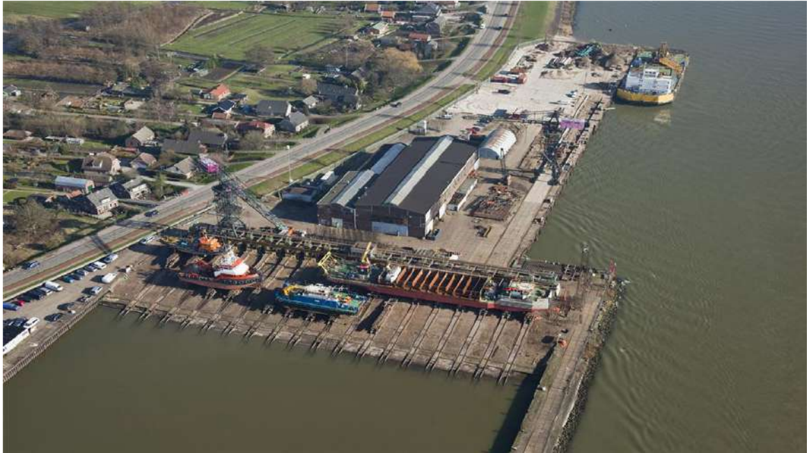
Рис. 1.2 Елінг на судноремонтному заводі Neptune (Голландія) призначений для підйому по рейкових шляхах відремонтованих суден
