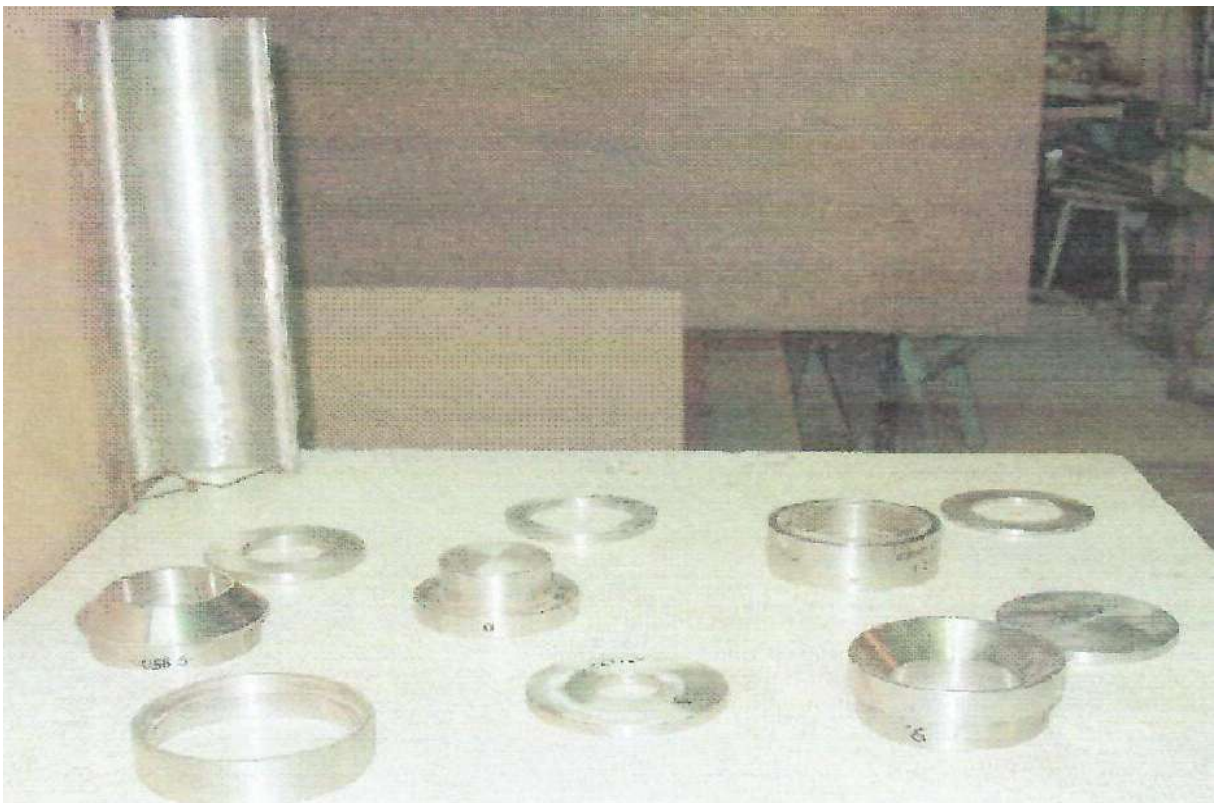
Рис. 4.5 - Конструктивні форми знімних наконечників вістря моделі палі-оболонки.
