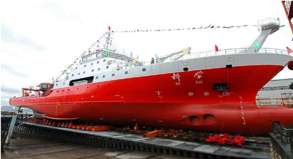
Рис. 1.1 Поздовжній елінг використовується для ремонту суден масою 10 тис. тон судно Кехуе готове до спуску на воду
