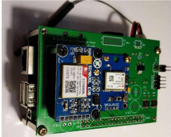
Рис. 3.36 Промисловий комп'ютер VPi-M1 +, призначений для збору даних переданих від вимірників
