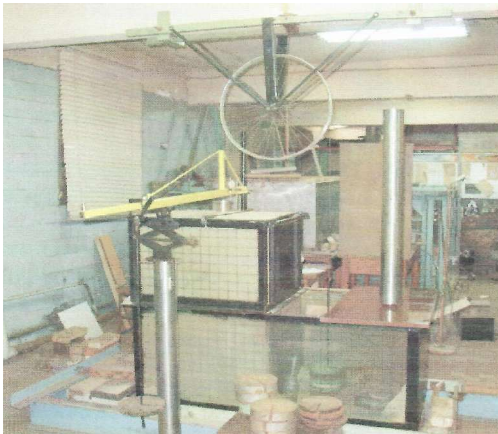
Рис. 4.3 Загальний вигляд експериментальної установки для випробування паль-оболонки і жорстких штампів
