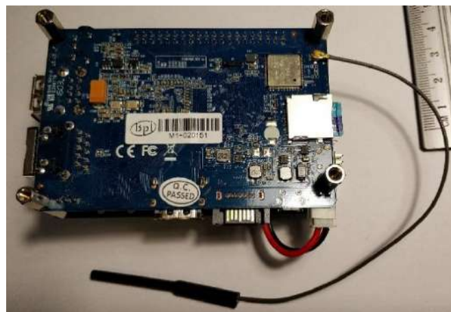
Рис 3.37 Промисловий комп'ютер VPi-M1 +, вид з боку приймача LoRa
