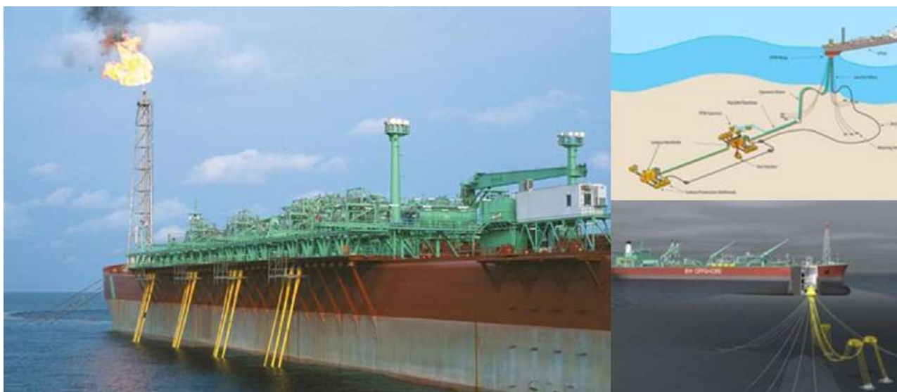
Рисунок А.9 - FPSO (floating production, storage, and offloading vessel) судно для видобутку, зберегання та відвантаження нафти
