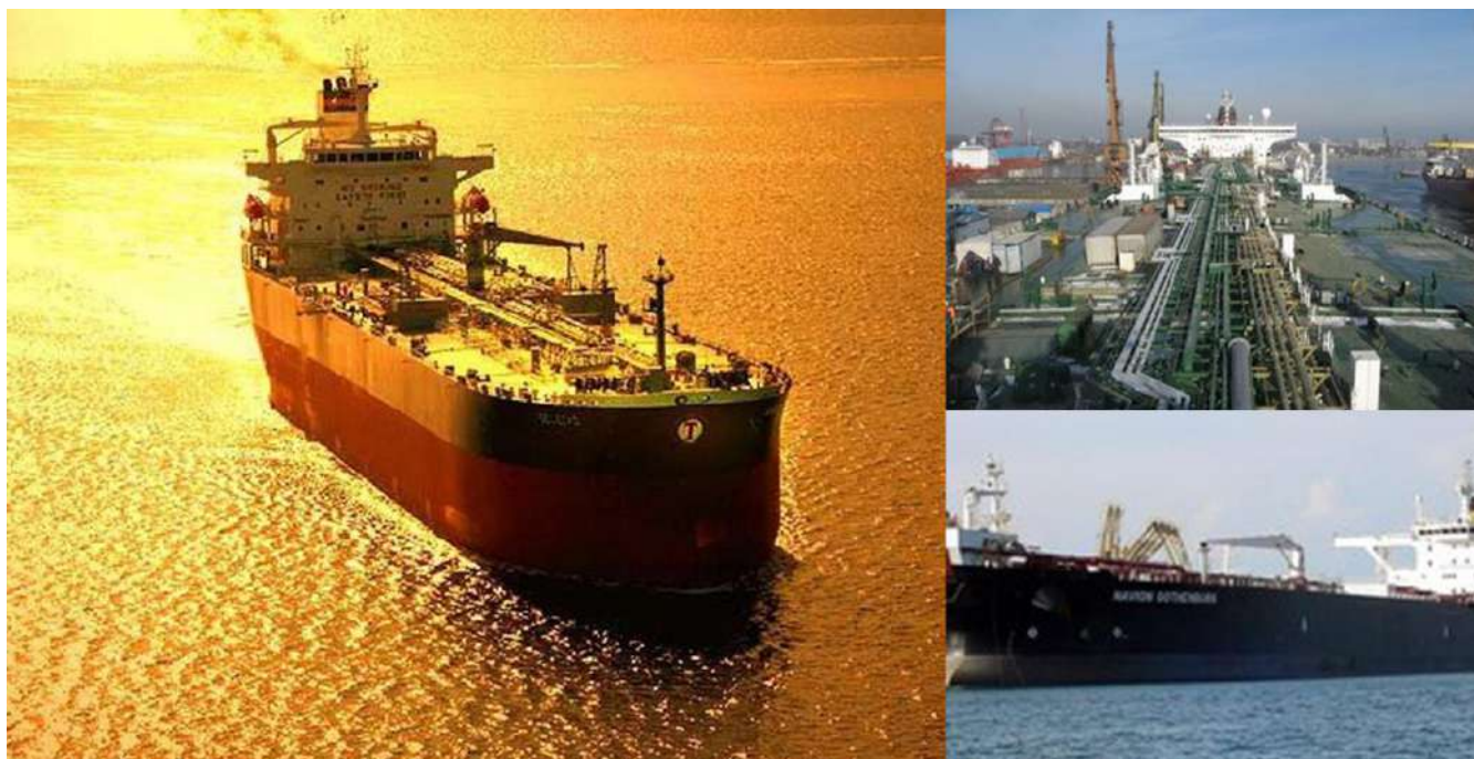
Рисунок А.8 - Шаттл-танкер, танкер-човник, також званий «плавучим трубопроводом» (Floating Pipeline), служить для навантаження сирої нафти з нафтових платформ, або суден типу FPSO.
