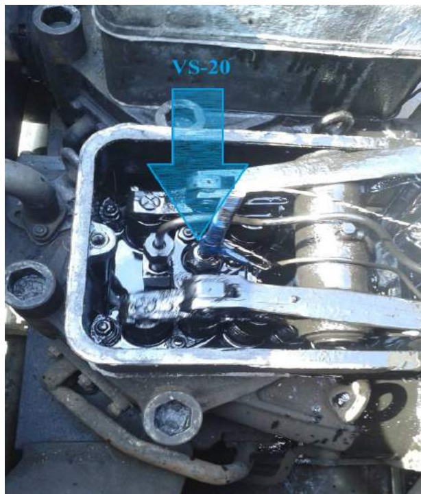
Рис. 4.3 – Установка віброакустичного датчика VS-20 на форсунку при знятому ковпаку кришки циліндра
