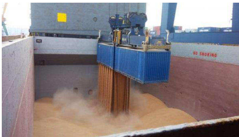
Рисунок В.3- Використання контейнерів в процесі завантаження судна
