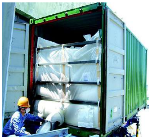
Рисунок В.1 - Стафіровка контейнера з використанням поліпропіленового вкладиша
