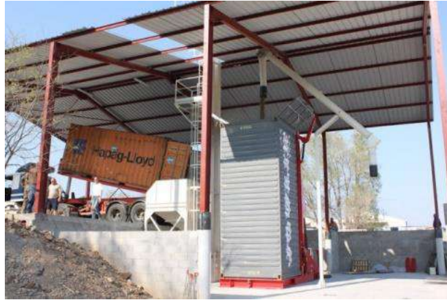
Рисунок В.2 - Стафіровка контейнера за допомогою системи контейнерних перекидачів
