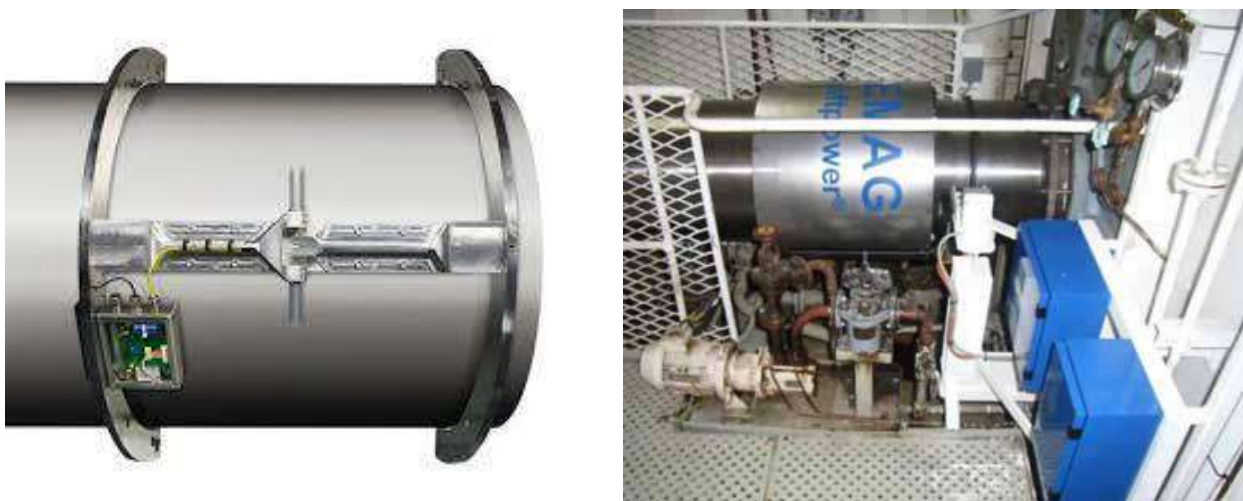
Рис. 1.11 – Секція валолінії з встановленими датчиками положення
