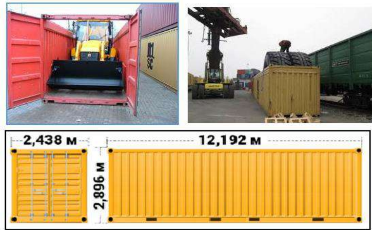
Рисунок 1.27 - Зовнішні розміри морського 40-футового (НС) контейнера
