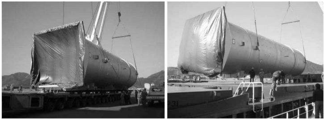
Рисунок 2.18 - Завантаження одиниці вантажного місця на палубу судна
