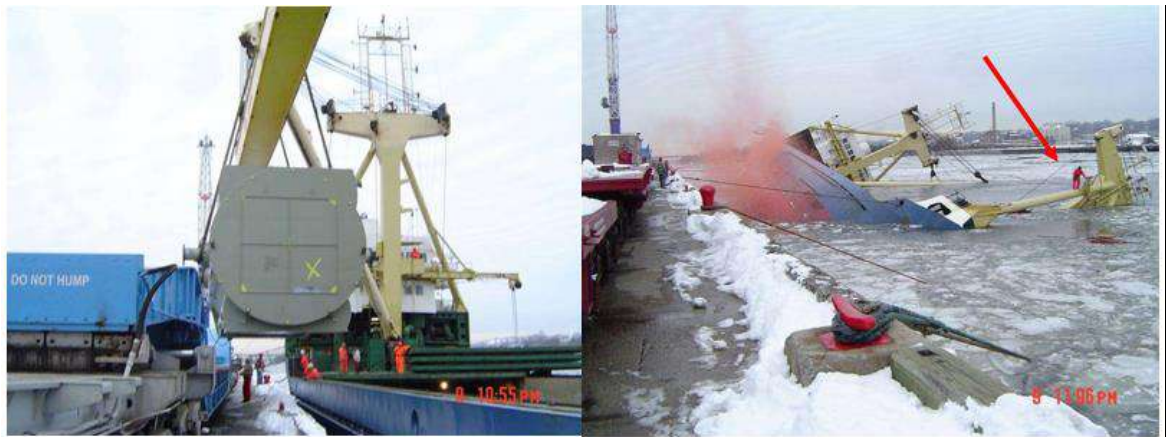
Рисунок 2.14 – Втрата остійності судна під час завантаження негабаритного і великовагового вантажу
