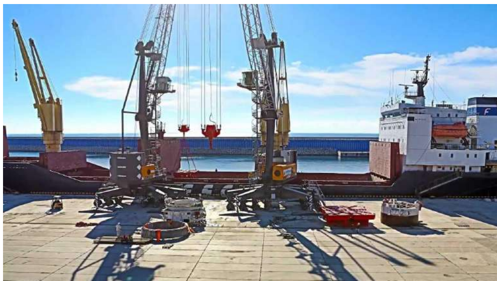
Рисунок 2.6 – Завантаження НВВ на судно-балкер за допомогою автокрану
