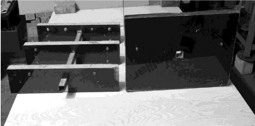
Рисунок 3.13 - Моделі одиночної анкерної плити і «гребінки» з вертикальним положенням плит
