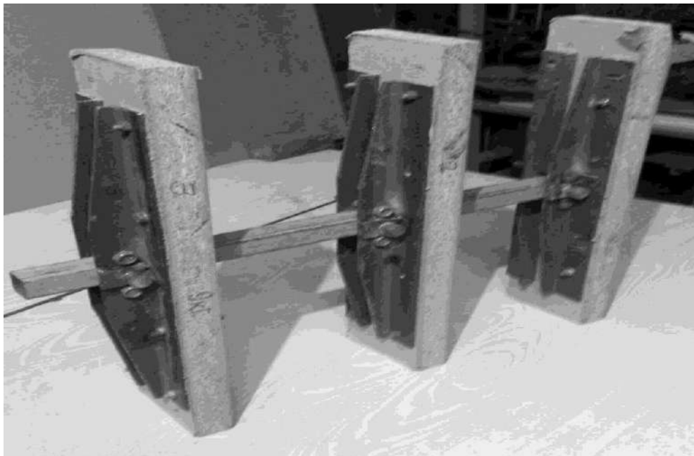
Рисунок 3.14 - Модель анкерного пристрою у вигляді «гребінки» з вертикальним положенням плит. Зображено особливості кріплення анкерної тяги до моделі «гребінки»
