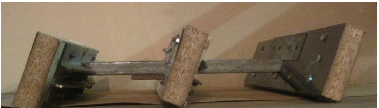
Рисунок 3.15 - Модель анкерного пристрою у вигляді «гребінки» з похилим положенням плит під кутом 20^{\circ}
