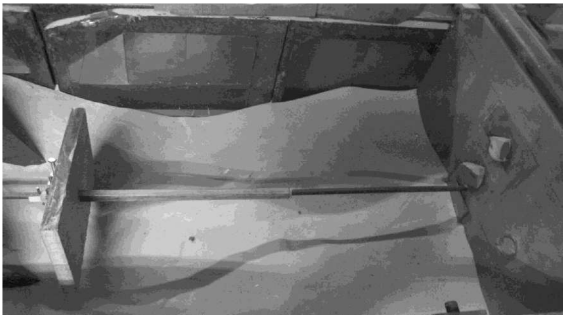
Рисунок 3.11 - Модель типової конструкції одиночної плити всередині установки до відсіпання піску
