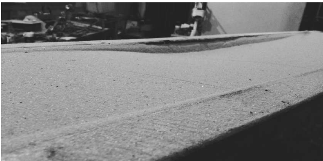
Фото 8 - Зображення результатів проведення додаткового дослід з профарбованими смугами піску: демонструється поява провалу на поверхні засипки поза анкерною опорою, вид збоку
