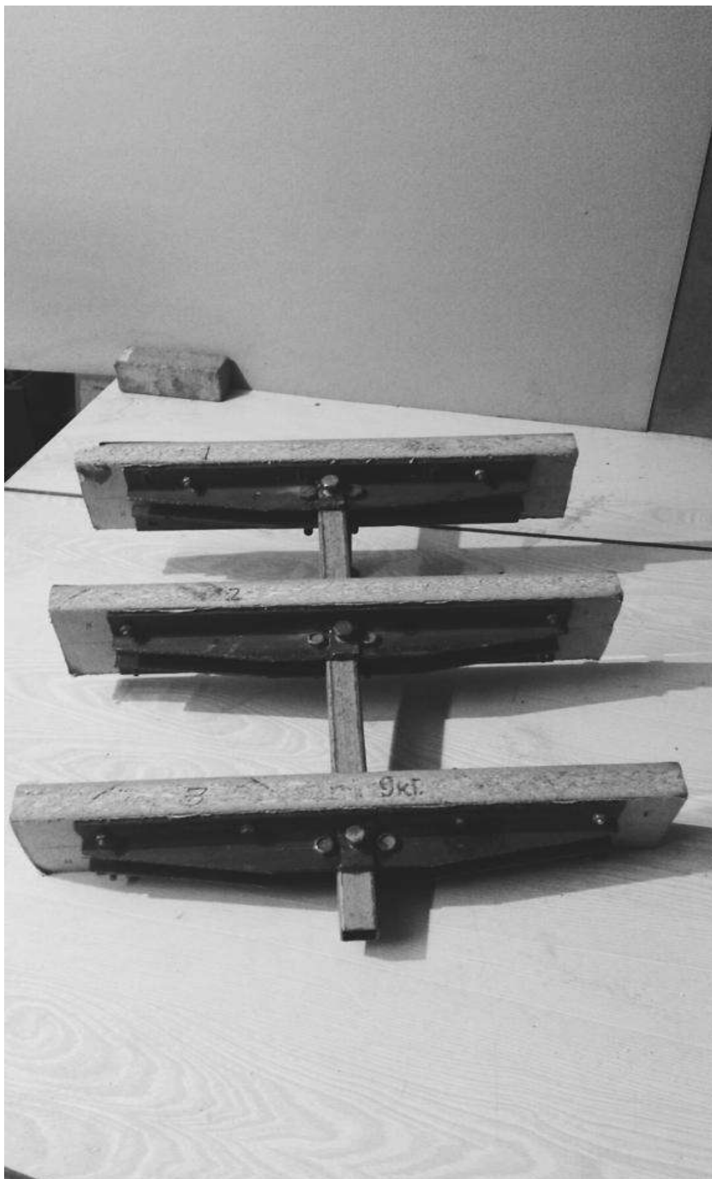
Фото 6 - Модель анкерної опори у вигляді «гребінки» з плитами різного розміру
