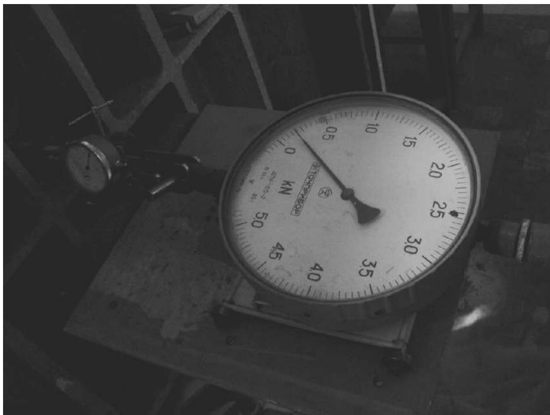
Фото 2 - Динамометр марки ДПУ-0,5-2 5 кН для фіксації зусиль, що діють на анкерну опору
