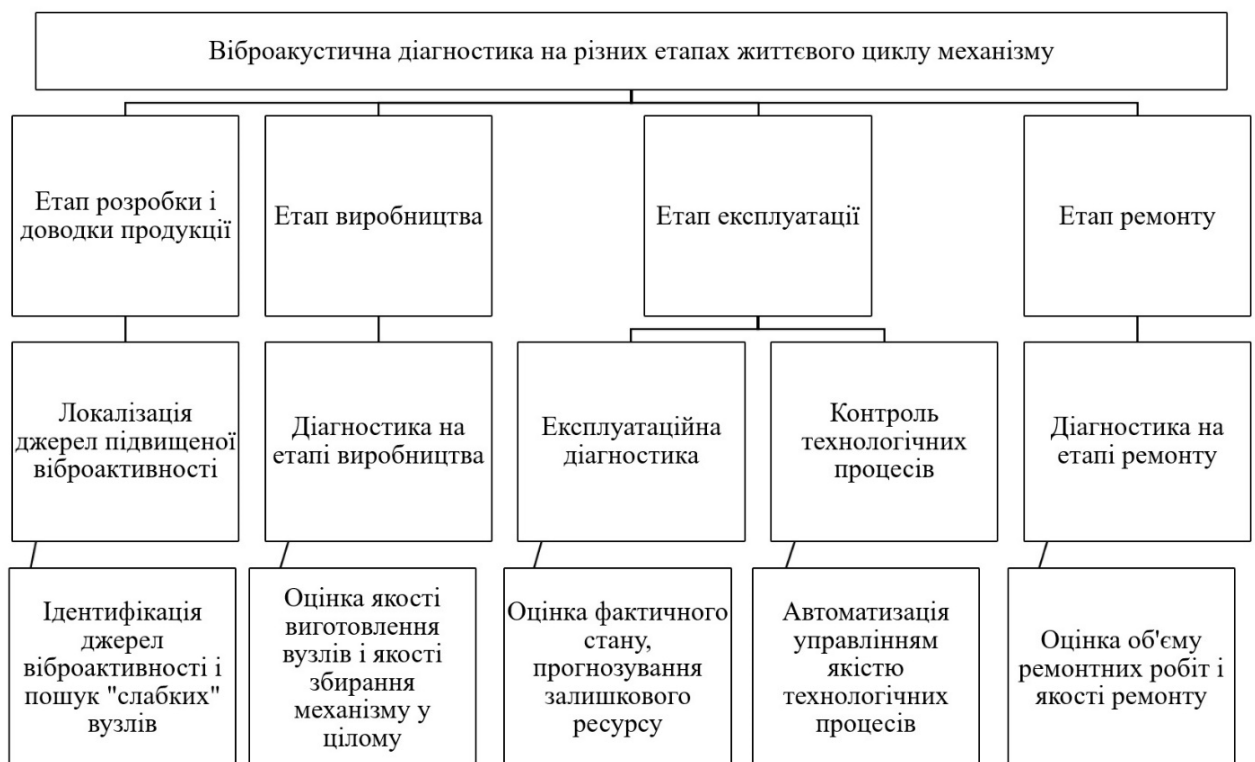
Рисунок 1.4 – Области застосування віброакустичного діагностування на етапах життєвого циклу механізму
